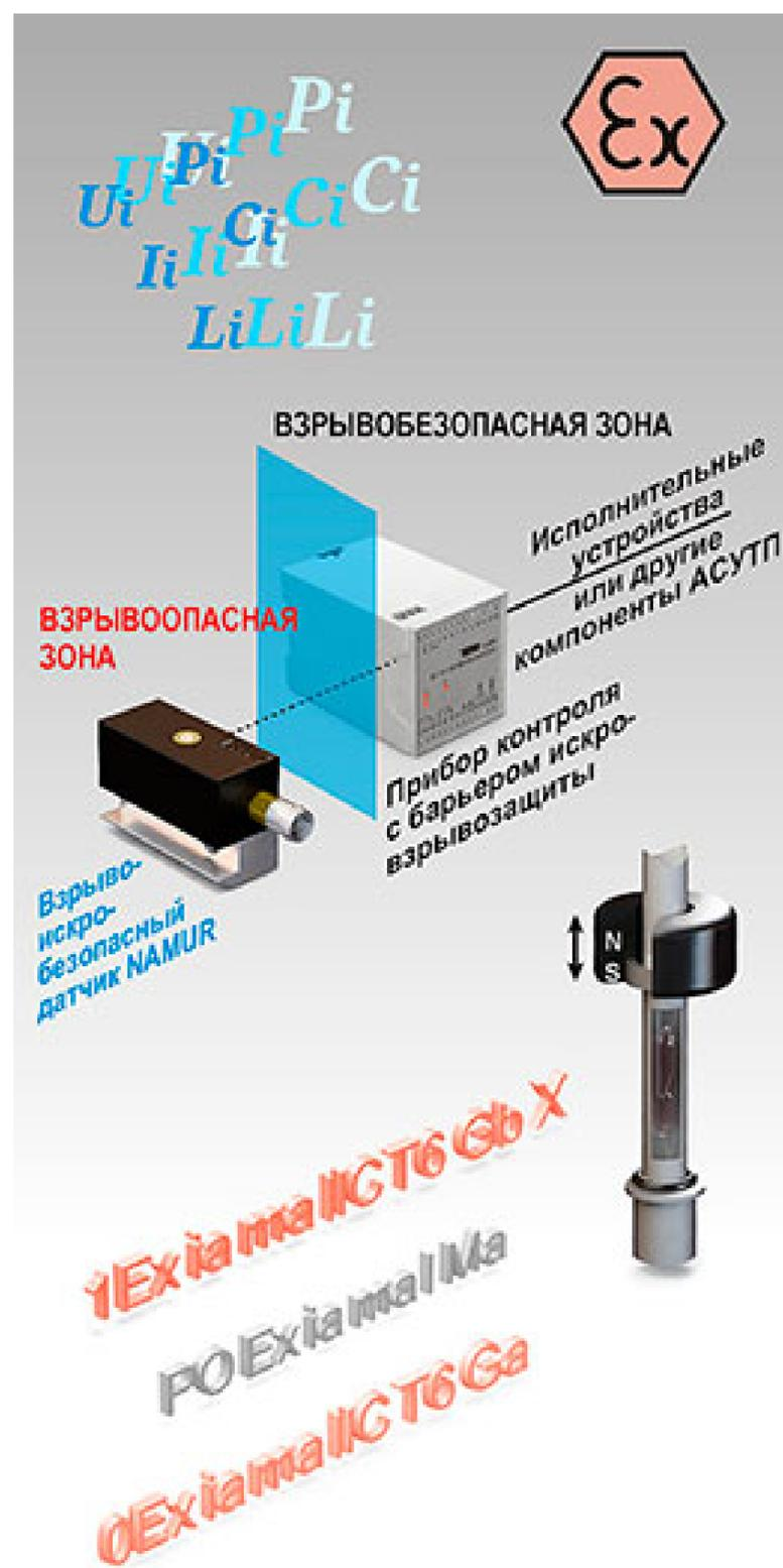
**0Ex ia ma IIC T6 Ga / 0Ex ia ma IIC T4 Ga** Маркировка взрывозащиты для помещений и наружных установок
