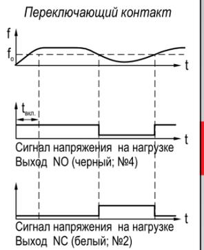
f - частота воздействия на датчик
