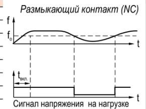
f - частота воздействия на датчик
