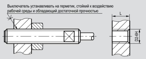
D2 = d2      d2 - номинальный диаметр резьбовой части выключателя
