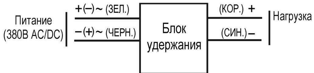
Рисунок 1. Схема подключения Блока Удержания.
